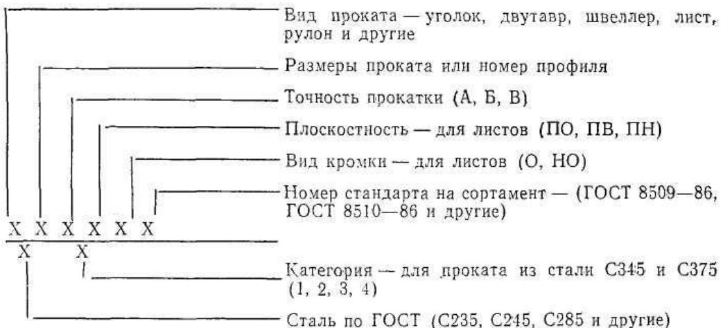
Прокат угловой равнополочный, обычной точности прокатки (В), размерами  $75 \times 75 \times 6$  мм по ГОСТ 8509-86, из стали С245 по ГОСТ 27772-88.
